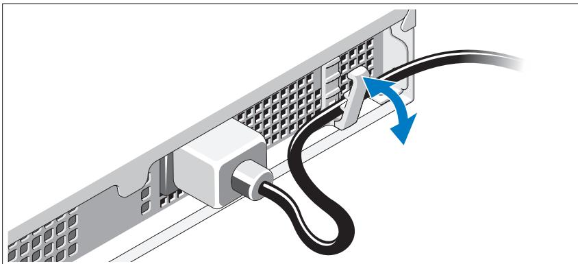
Dobre o cabo de alimentação conforme mostrado na ilustração e fixe o cabo na presilha de fixação.
