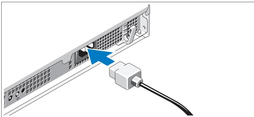
Conecte el cable de alimentación al sistema y, si se utiliza un monitor, conecte el cable de alimentación correspondiente al monitor.
