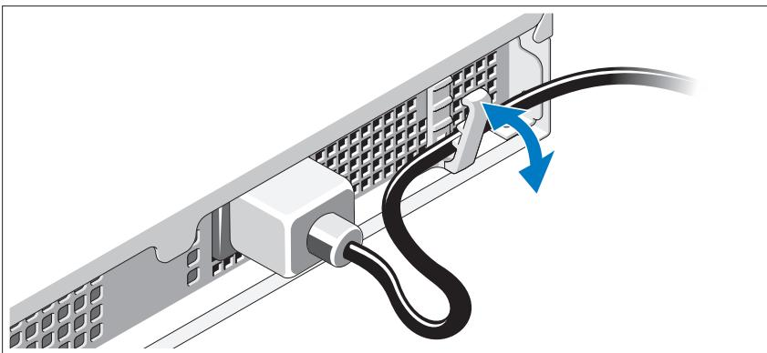
Pliez le câble d'alimentation comme le montre l'illustration et faites-le passer dans le clip de fixation.
