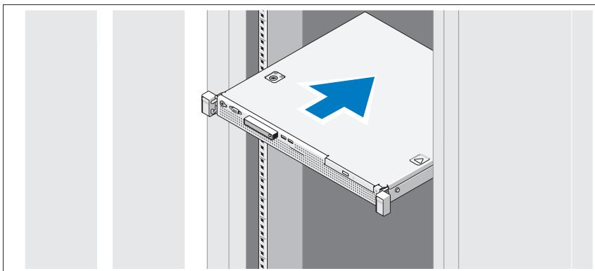
Assemblez les rails et installez le système dans le rack en suivant les consignes de sécurité et les instructions d'installation du rack fournies avec votre système.
